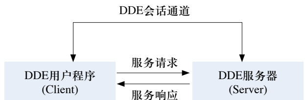
图3 DDE链接示意
