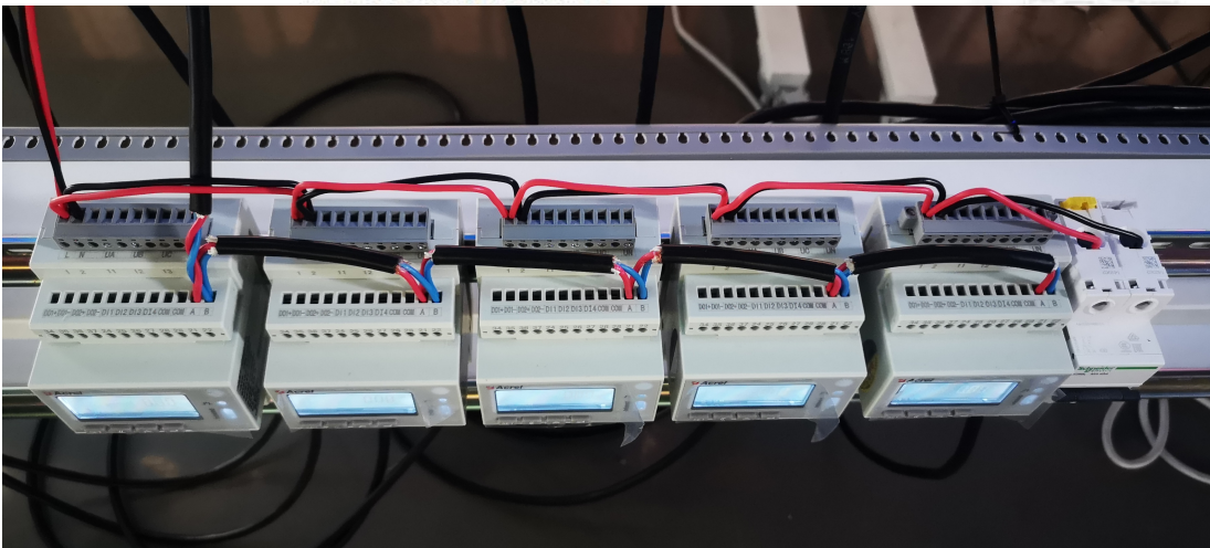
RS485总线组网接线图
